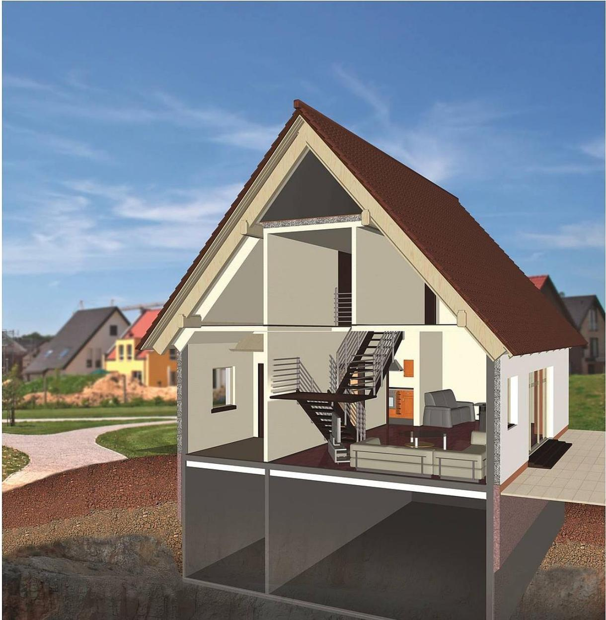
Zu einem Vollwärmeschutz gehören neben den Außenflächen auch viele Anschluss-Bauteile und auch Innendämmungen wie die der Zwischendecke. (Grafik: CAPAROL Farben Lacke Bautenschutz GmbH)
