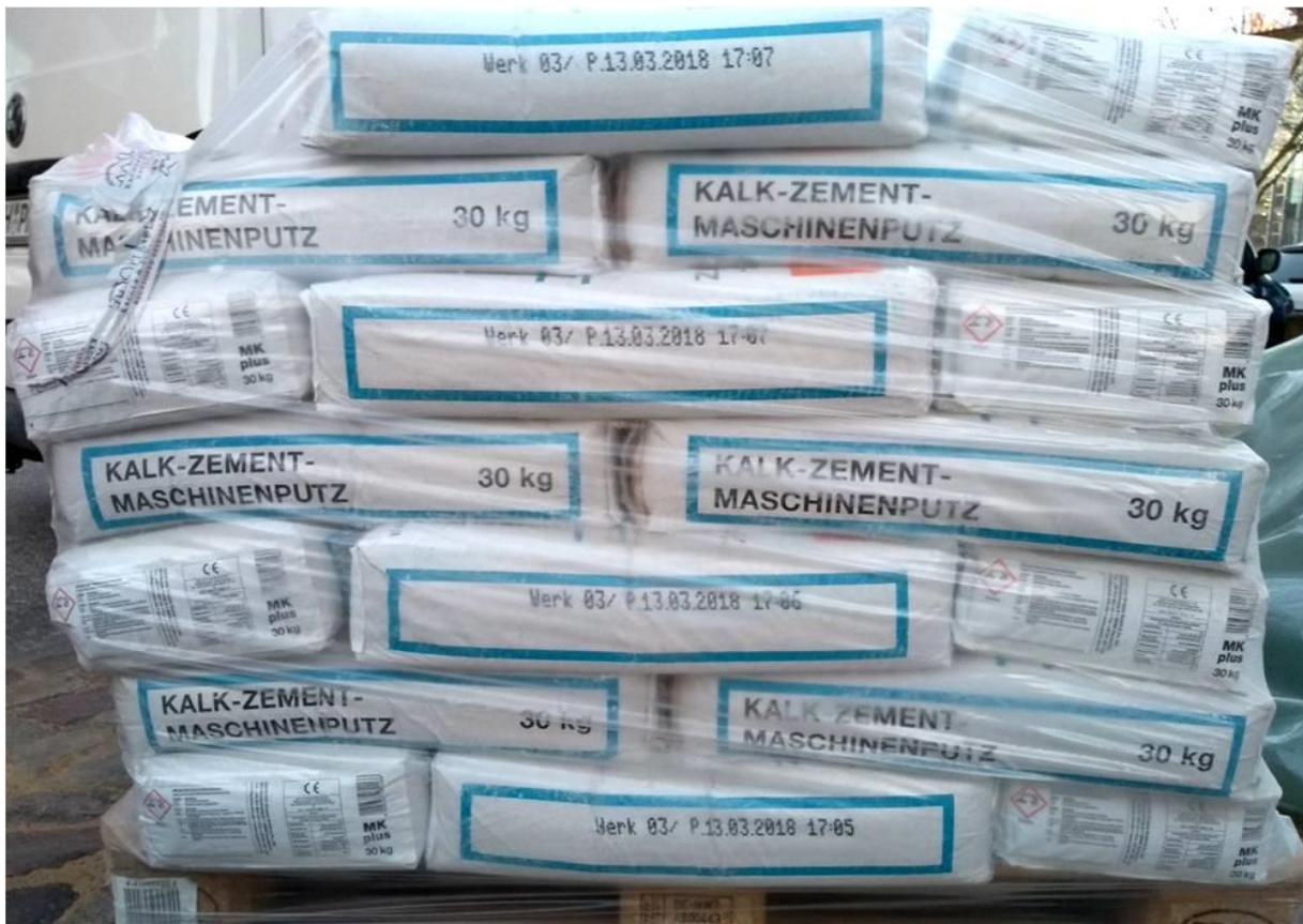
Kalkzementputz (hier: Quick-Mix Kalk-Zement-Maschinenputz MK plus 30 kg/Sack) ist im Außenbereich für Wandbaustoffe mit normalen wärmedämmenden Eigenschaften, als Innenputz für Feuchträume, Treppenhäuser, Keller, Bäder, Garagen u. ä. und im Außenbereich zur Aufnahme von Edelputzen, Beschichtungen oder mineralischen Anstrichen geeignet. (Foto: energie-experten.org)
